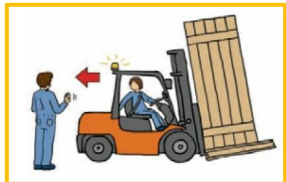
La subida o bajada de pendientes se debe hacer a velocidad reducida. En pendientes con un desnivel superior al 10 por ciento, el montacargas se conducirá con la carga cuesta arriba. La carga debe inclinarse hacia atrás y elevarse sólo lo necesario para que no toque la superficie del suelo. El solo hecho de virar en una pendiente se rompe la relación del triángulo de equilibrio con el centro de gravedad, provocando el vuelco del equipo (**TIPPING**).
