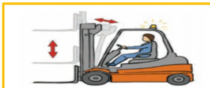
La inclinación del mástil y de las horquillas, así como verificar que se desplazan lentamente
