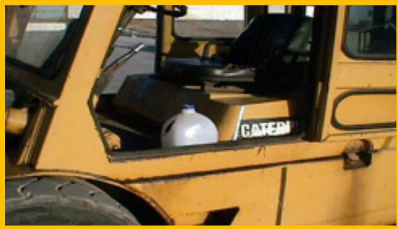
Se prohíbe transportar o colocar en la cabina del montacargas cualquier clase de recipientes que contengan solventes, combustibles o líquidos inflamables en general.
