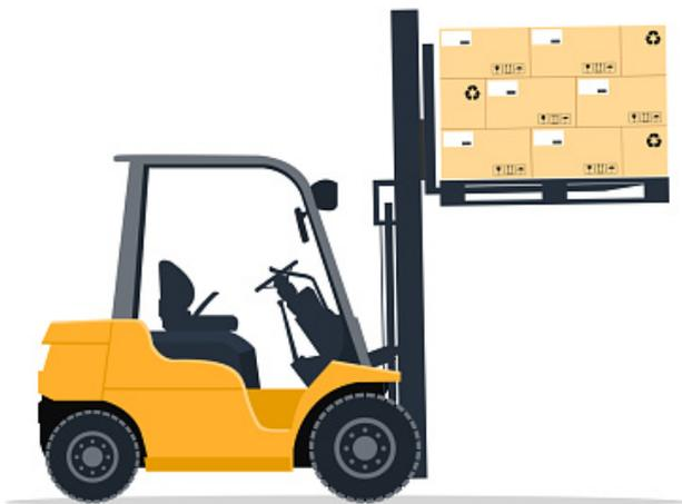
Entre los equipos mecanizados más utilizados, por su versatilidad, está la **Grúa Horquilla o Montacargas**, que permite realizar prácticamente todas las operaciones de manejo de materiales con excelente rendimiento para diferentes tipos de materiales y lugares de trabajo.
