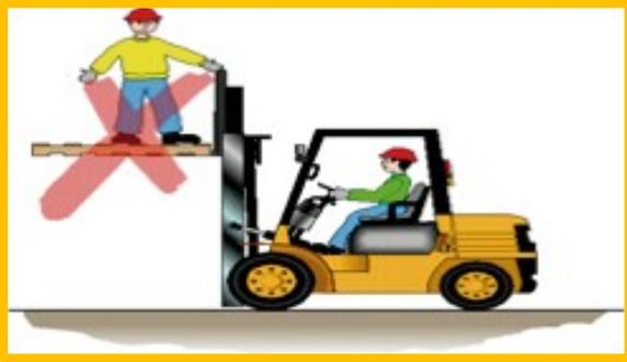
No debe usarse la grúa para llevar personas en sus horquillas, remolques ni cualquier otro elemento del montacargas para transportar pasajeros. Será responsabilidad del operador evitar que alguien suba al equipo.
