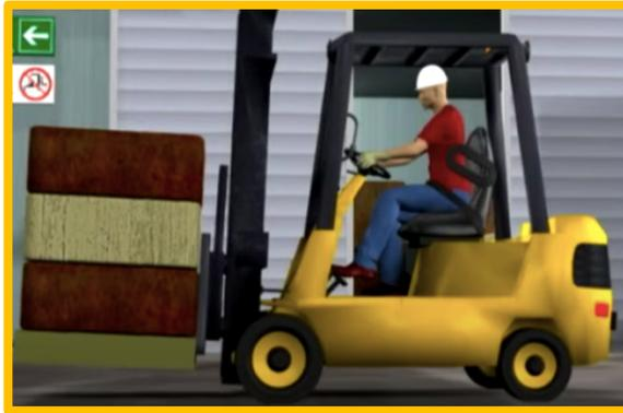
Al transportar una carga debe inclinar la torre hacia atrás, de acuerdo a la naturaleza de la carga. La inclinación hacia atrás de la torre mantiene la carga uniforme y segura.
