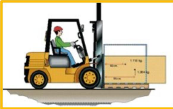
Todo montacargas tiene estipulado por el fabricante la carga límite indicada en un Placa ubicada en un lugar visible del equipo.
