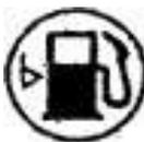
**NIVEL DE COMBUSTIBLE.-** Se encenderá el indicador cuando el combustible alcance el 10% de la capacidad del tanque. Para no quedarse sin combustible y de ser posible, reabastezca la máquina dentro de una hora.
