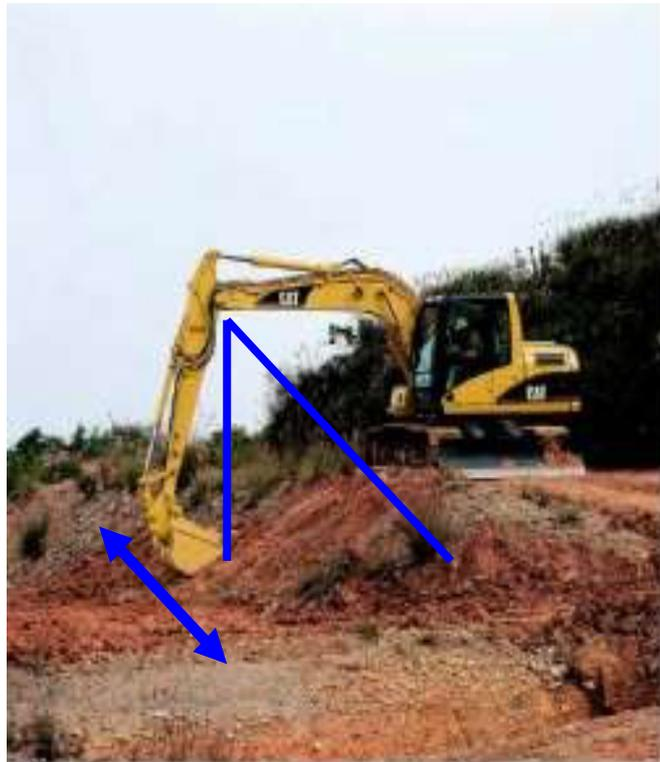
4. Coloque el cucharón a un ángulo de **120°** aproximadamente con respecto al terreno con esta maniobra se ejercerá la fuerza necesaria de penetración del cucharón en el terreno.
