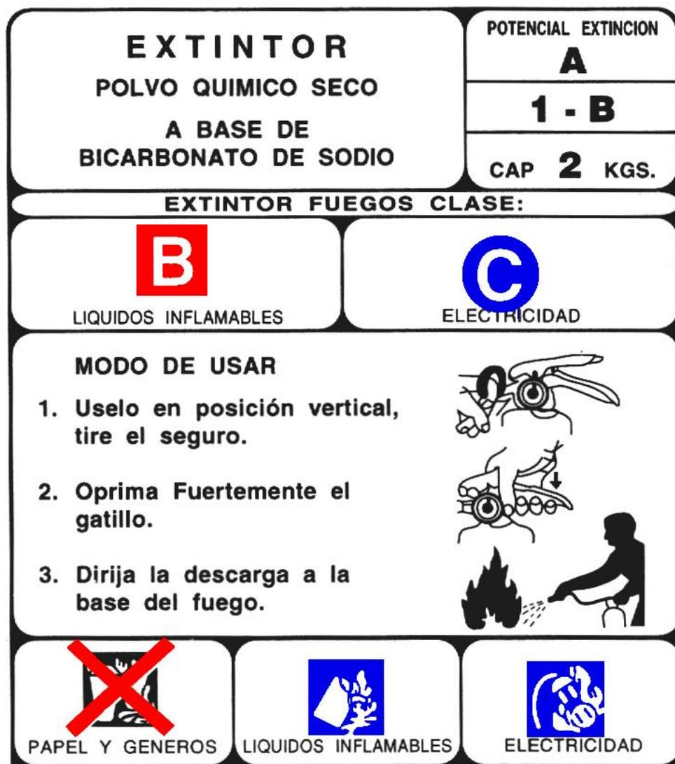
Las instrucciones de uso, deben ser proporcionadas por el fabricante o importador mediante un rótulo o etiqueta firmemente adherida en la parte del cilindro que resulte más visible cuando el extintor se encuentra en su posición y ubicación normal.
